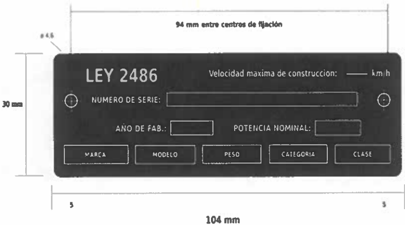
FIGURA 2. DIMENSIONES DE LA LÁMINA DE MARCAJE PARA LEY 2486
